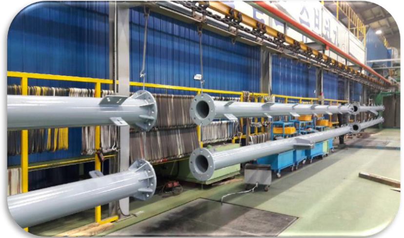
<< 가로등 도장 건조 후 전경 >>
